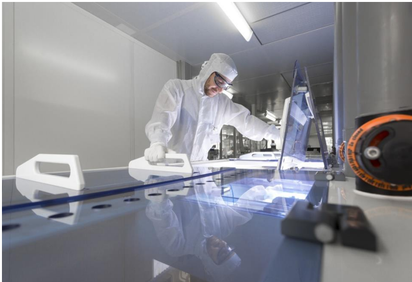
Durchlauf-Ätzanlage zur ozon-basierten Waferreinigung sowie einseitigen Emitterentfernung im »Front End« des Fraunhofer ISE Photovoltaik-Technologie Evaluations Center PV-TEC. ©Fraunhofer ISE/ Dirk Mahler
